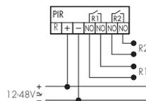
Regolazione automatica della luce in funzione della presenza e della luminosità e regolazione automatica RCV in funzione della presenza.
